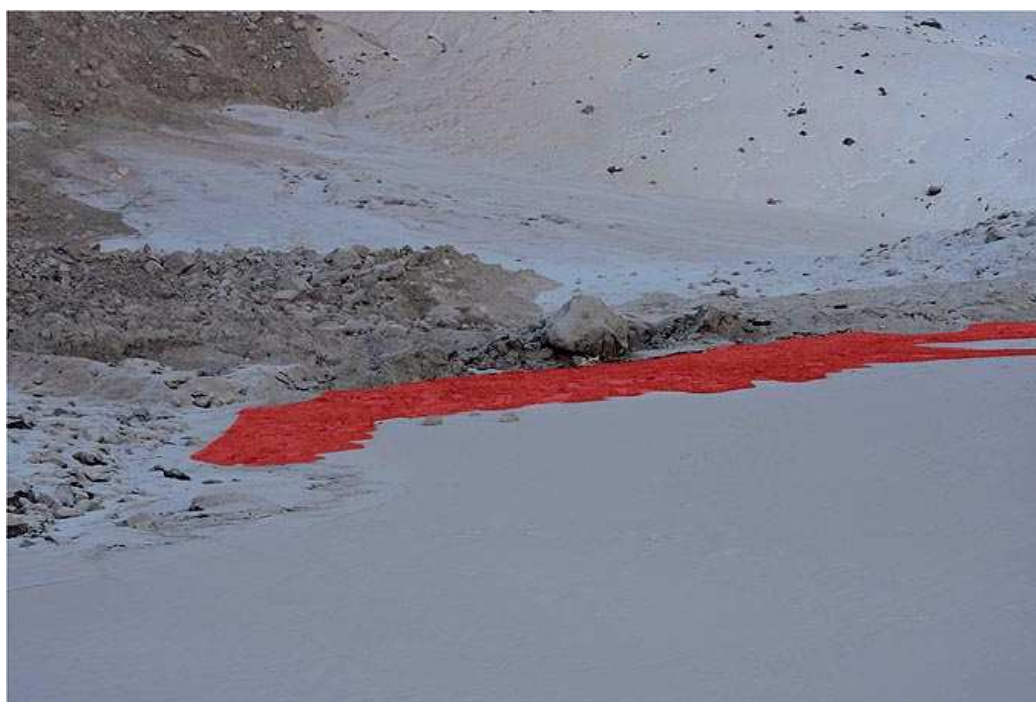
Figura 11 - La parte distale dell'accumulo di frana (evidenziata in rosso) è in parte sovrascorsa sulla superficie ghiacciata del Lago delle Locce. Non si può escludere che, in assenza di questa tavola di ghiaccio spessa 1015 cm, l'impatto della frana nel lago avrebbe potuto generare un'onda di sommersione, sia pure di modesta energia (f. Gianni Mortara, 19.12.2015).
